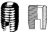
[Gewindemuffen M-Gewinde im Gfk erstellen](#)
